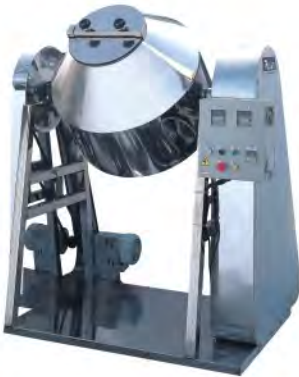
BT太陽式特殊型 內外旋轉型: 內部葉片120rpm反轉, 外部圓桶20rpm正轉, 專業用於粉末攪拌
