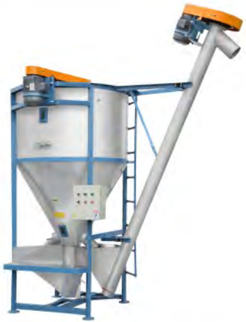
BV系列特殊型 加裝螺旋輸送機, 直接送往高處
